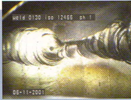
Afbeelding 2 Voorbeelden van afgekeurde lassen
